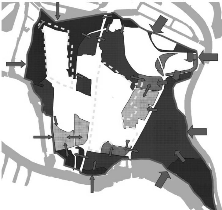
Abb. 15: Kompartimentierung der Elbinsel Hamburg-Wilhelmsburg, um eine zweite Deichlinie zu realisieren (flutbare Kompartimente in grau hinterlegt) (TU Hamburg-Harburg, Institut für Wasserbau 2007)
